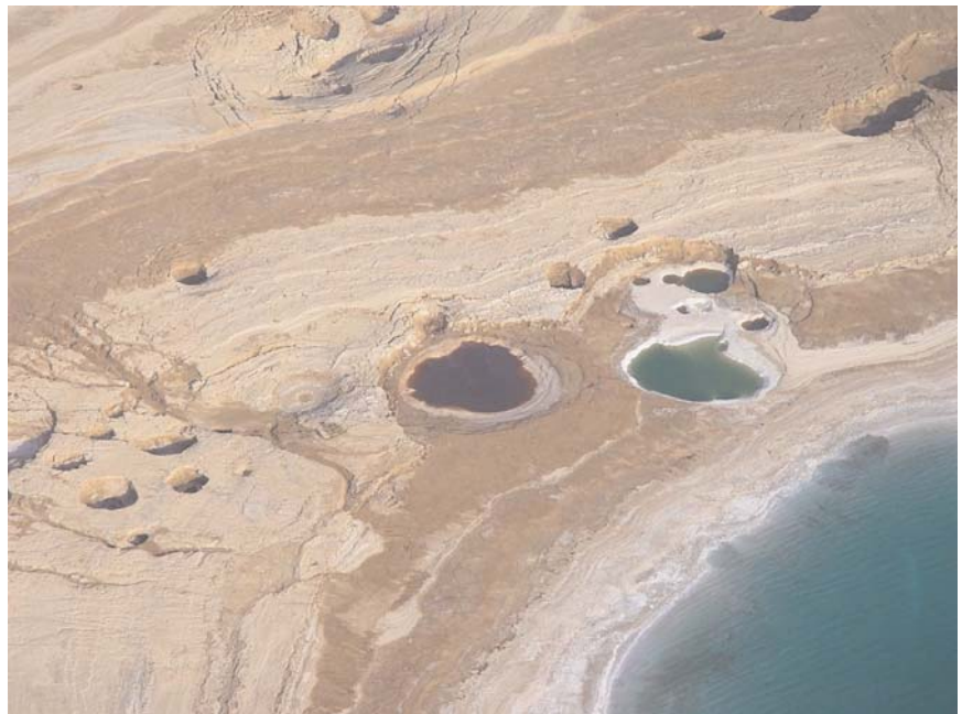
Fig. 13. Veduta aerea di sinkholes allagati nel Mar Morto, area di Ein Gedi. La parte alta dell'immagine è interessata da forte subsidenza, con forma da circolare a ellittica, delineata da fratture circolari, e con all'interno la presenza di vari sinkholes. Questo tipo di strutture composte è osservabile in più siti lungo la costa del Mar Morto, con l'esempio di maggiori dimensioni (500 x 300) in Giordania. Fonte: Internet, DAVID HOLLAND, 2005; fornita da D. CLOSSON). - Bird's eye view of flooded sinkholes in the Dead Sea, Ein Gedi area. The upper part of the picture shows strong subsidence with a circular to elliptical shape delineated by circular cracks. Sinkholes are proliferating inside. Such compound features can be found in many places along the coast. The biggest elliptical structures can be found in Jordan where they reach 500 m x 300 m. Source: the Internet, DAVID HOLLAND, 2005.
